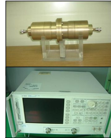
[그림1. 차폐측정지그 및 Spectrum Analyzer]
